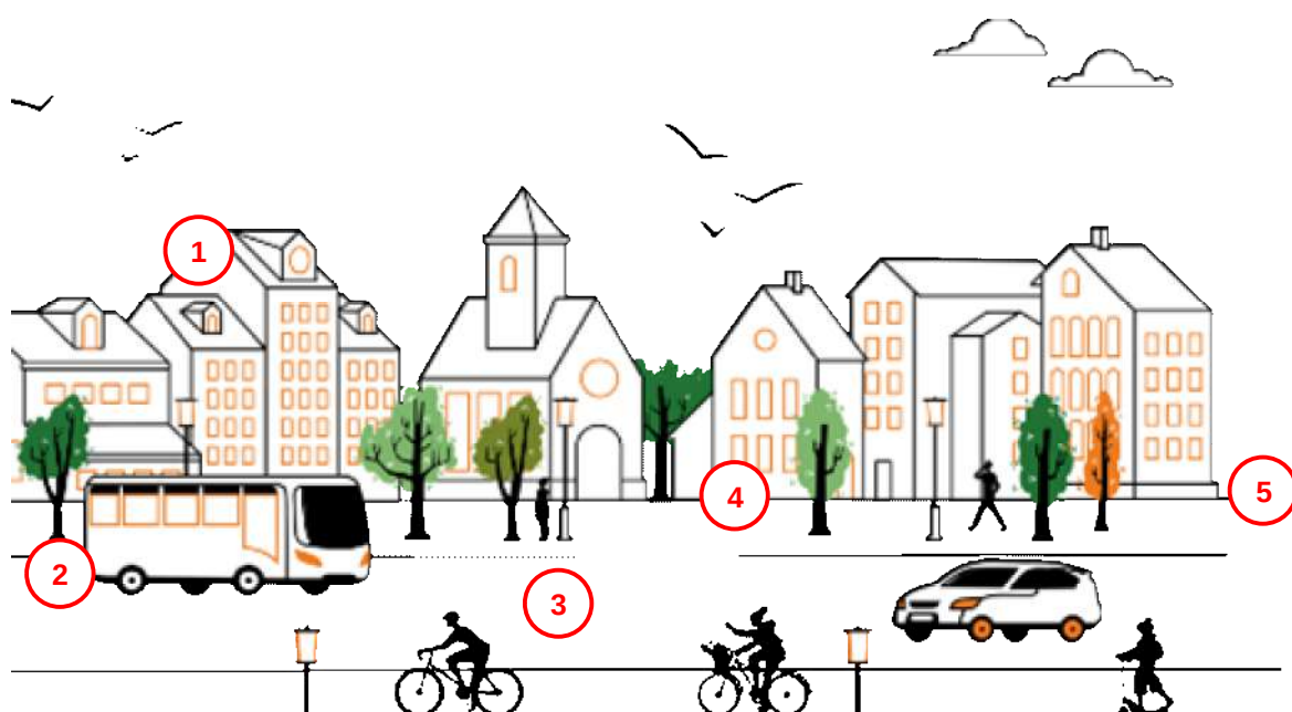
Figure 5 : Sources de pollution des eaux pluviales
