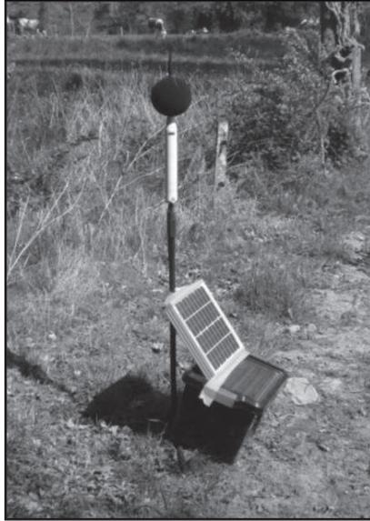
*Appareil de mesure des niveaux sonores*
